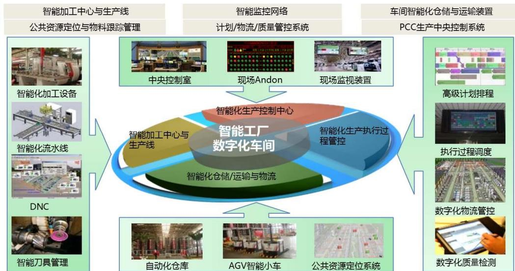
图 2-11 三一重工 18 号智能工厂实施架构
