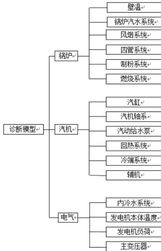
图 8-1 诊断模型故障树
