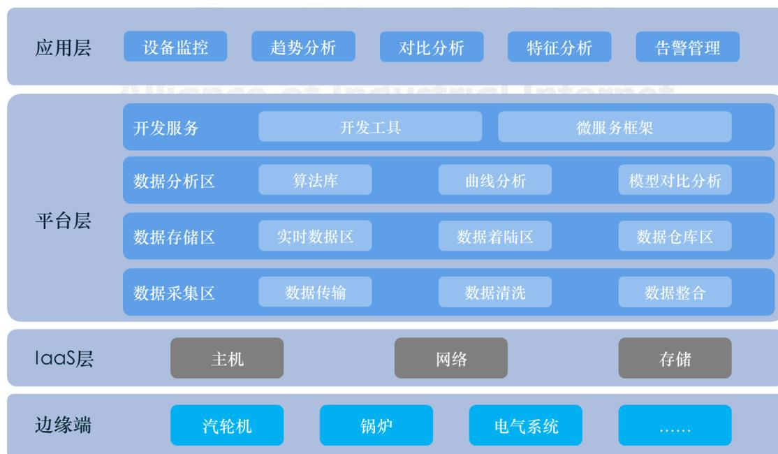
图 8-2 火电机组运行特性分析实施架构
