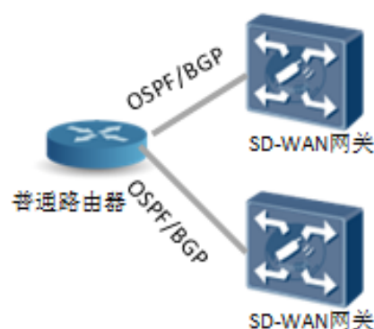
图 7 采用动态路由协议的网关冗余
