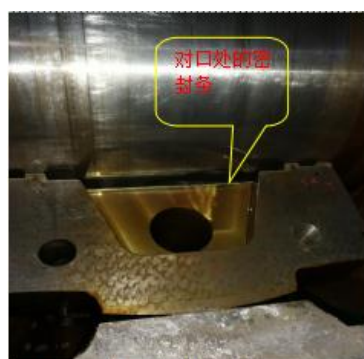
图 1:1 瓦对口处的密封条
