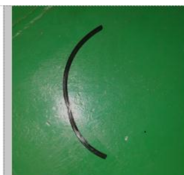
图 2:1 瓦对口处取出的橡胶密封条
