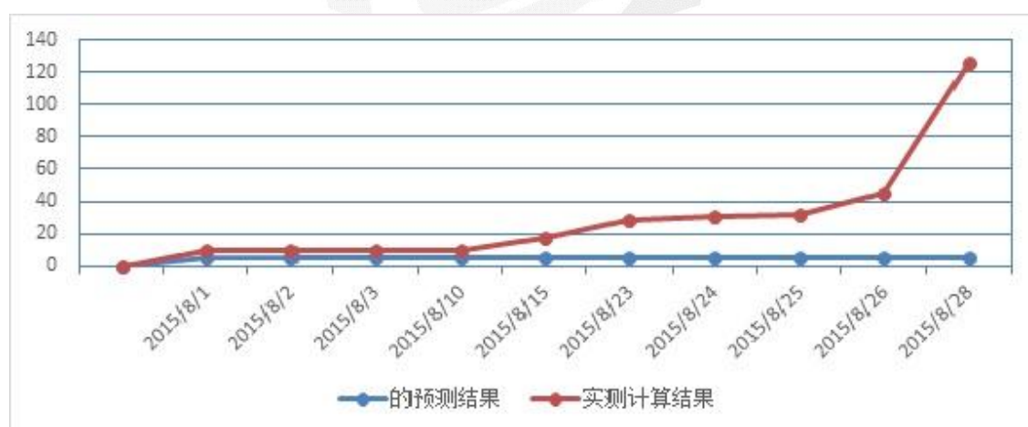
图 6 水力不平衡故障指标预测结果和实测结果对比图
