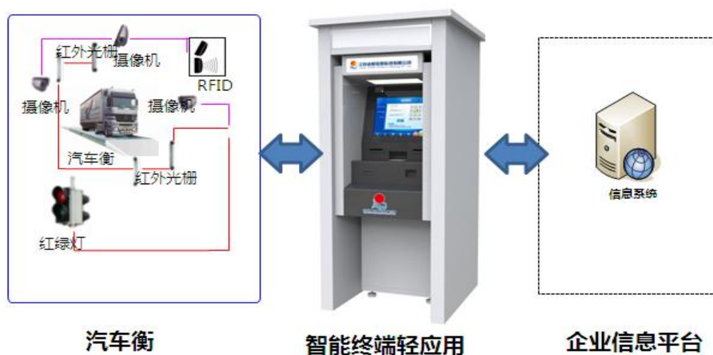
图 2 远程计量系统示意图
