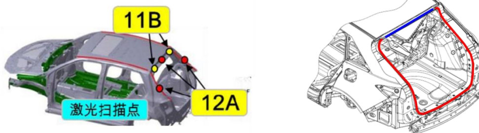
图4 3D激光引导定位系统定位示意图
