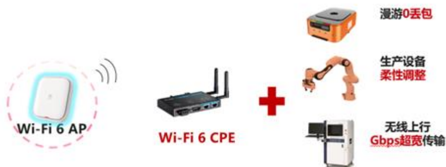
图 7-13 Wi-Fi 6 CPE 实现多协议接入
