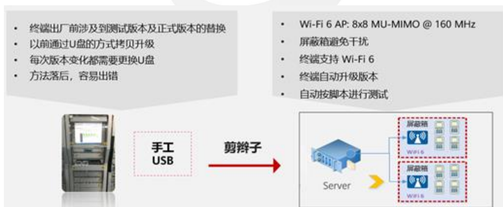
图 7-15 Wi-Fi 6 无线自动升级实现自动化测试
