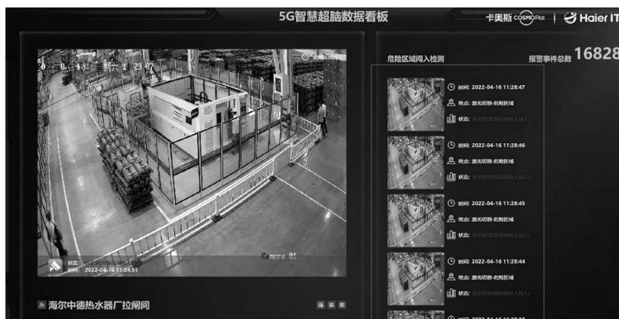
图 8 海尔智慧工厂的电子围栏监控平台
