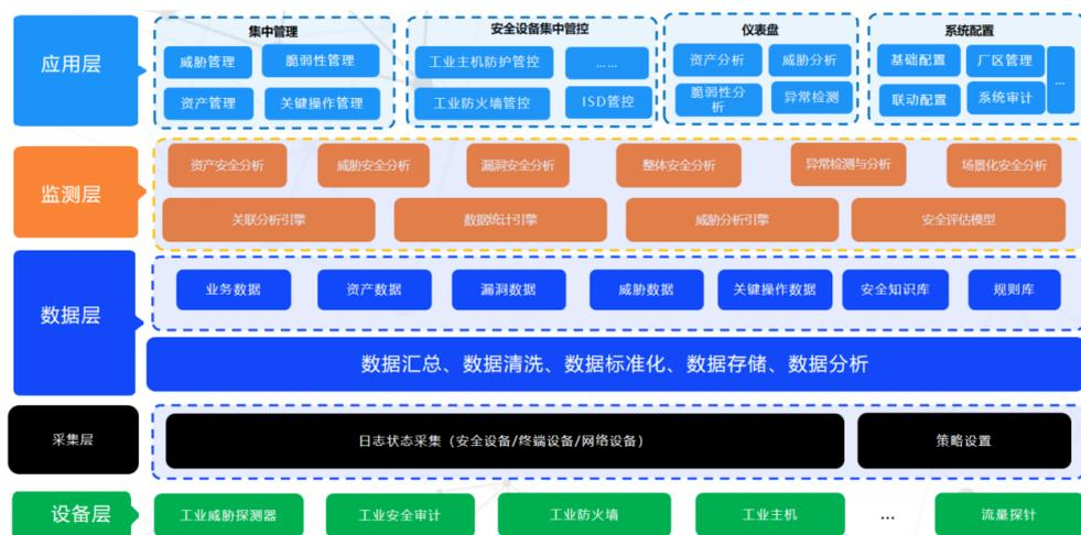
图 1 工业互联网安全运营中心系统整体架构
