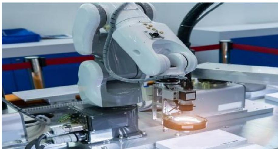
图表 5 机器视觉检测
