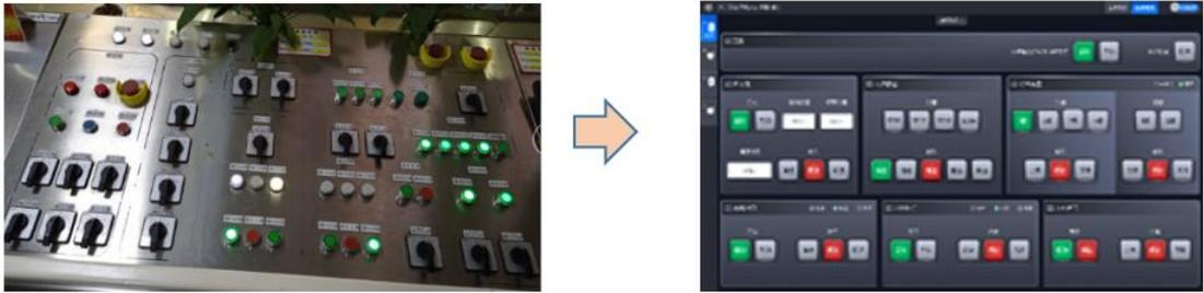
图 7 PLC 软控制台
