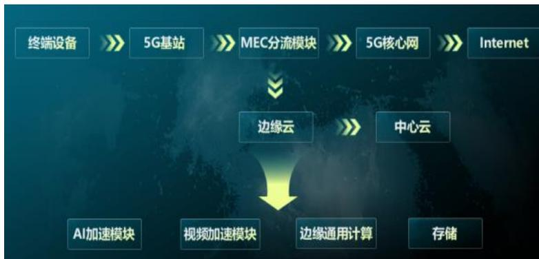
图表 2 基于 5G MEC 边缘云技术的网络拓扑图
