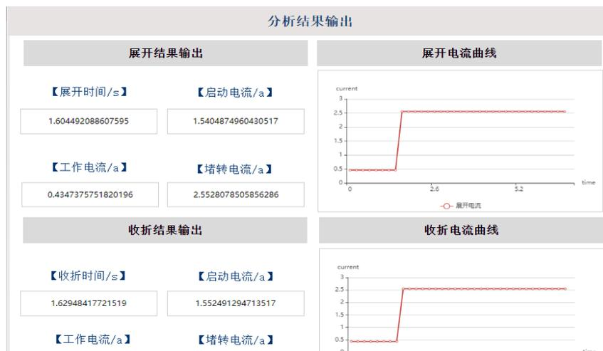
图9 后视镜电动折叠分析 APP 输出计算结果
