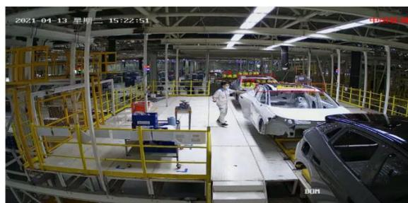
图 3-2 天窗清擦和底涂操作工序合规 5G+AI 视觉检测现场图
